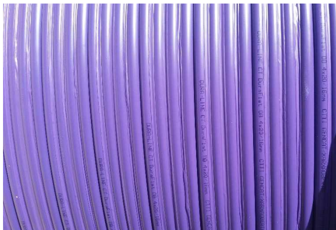
Exemple de marcatge de microducte personalitzat
