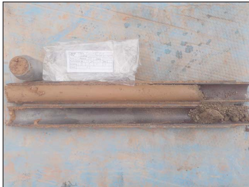
Fotografia 4. Detall dels materials recuperats en l'assaig SPT-1 realitzat entre les cotes de -1.50 a -2.10 m de profunditat.
