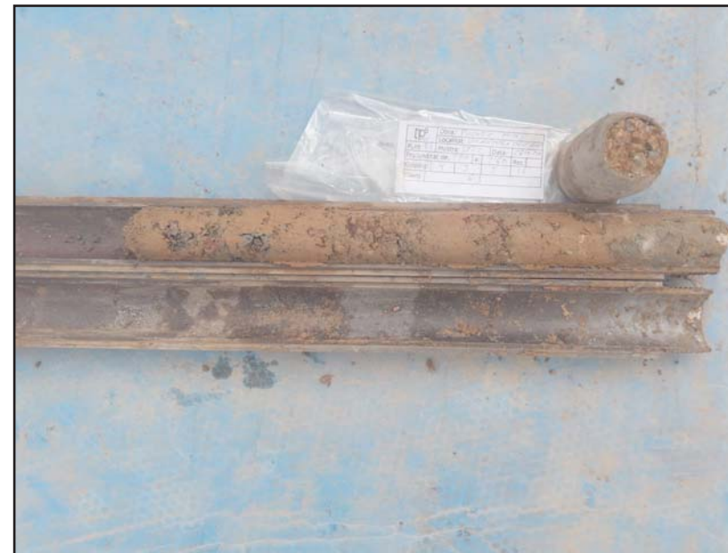
Fotografia 5. Detall dels materials recuperats en l'assaig SPT-2 realitzat entre les cotes de -3.00 a -3.60 m de profunditat.
