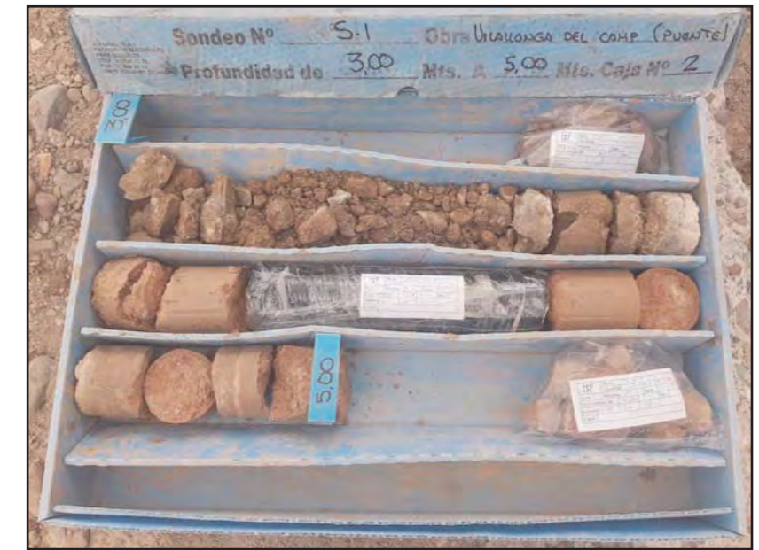
Fotografia 3. Detall dels materials recuperats durant la realització del sondeig a rotació amb bateria contínua S-1, entre les cotes de -3.00 a -5.41 metres de profunditat.
