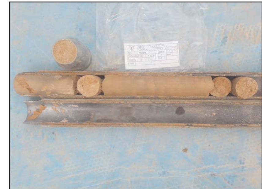
Fotografia 6. Detall dels materials recuperats en l'assaig SPT-3 realitzat entre les cotes de -5.00 a -5.41 m de profunditat.
