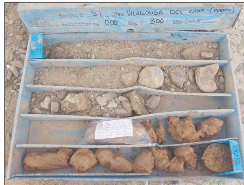
Fotografia 2. Detall dels materials recuperats durant la realització del sondeig a rotació amb bateria contínua S-1, entre les cotes de 0.00 a -3.00 metres de profunditat.
